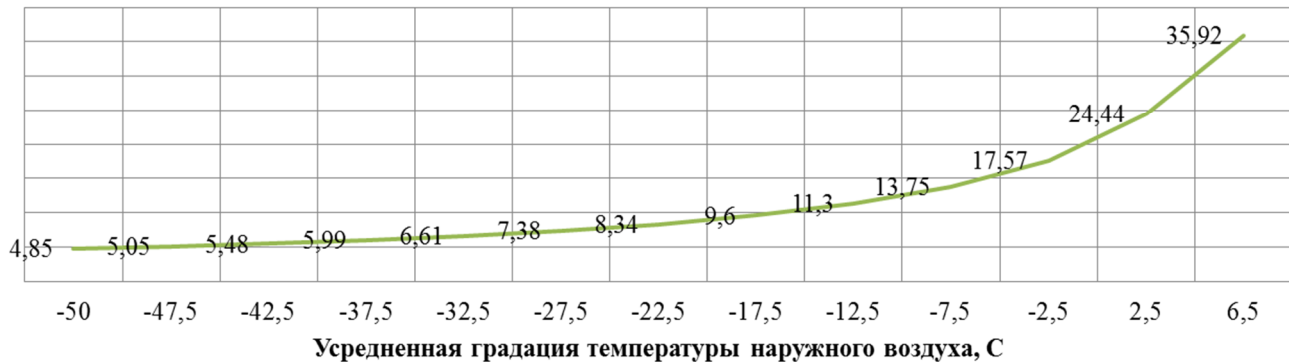
Рисунок 10.1 - График зависимости времени падения температуры внутри помещений от температуры наружного воздуха
